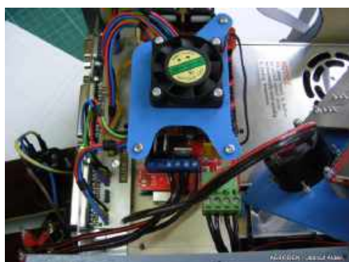
Ustawienie płytek i złącza DB25
