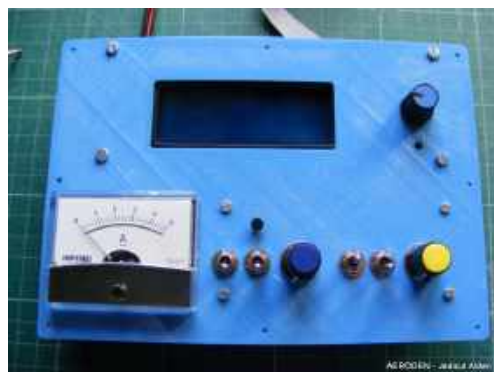
Pł. czołowa, amperomierz wskazuje wartość prądu przepływającego przez gorący drut.
