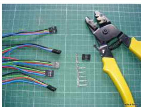
Przygotowanie wiązek kabli i gniazd do połączenia z ramps 1.4
