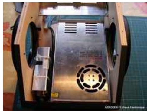
Zasilacz gorącego drutu po prawej stronie 36V 10A i zasilacz elektroniki 12V 10A po lewej stronie, bez obudowy w celu lepszego chłodzenia.
