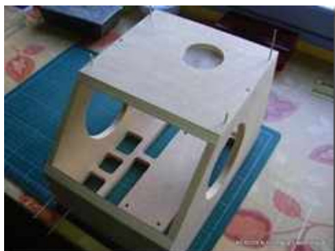
Obudowa z dużą ilością otworów wentylacyjnych.
