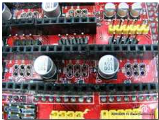
Cięcie ścieżek za pomocą frezu i mini-wiertarki. Identyczne traktowanie 5 osi płytki Ramps 1.4.
