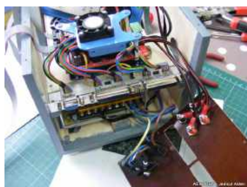
Widok złącza sieciowego wyposażonego w bezpiecznik 5 \times 2 \text{ 8 A} ; Idealnym byłby bezpiecznik opóźniony o wartości 5 A wytrzymujący pobór prądu rozruchowego z 2 zasilaczy impulsowych.
