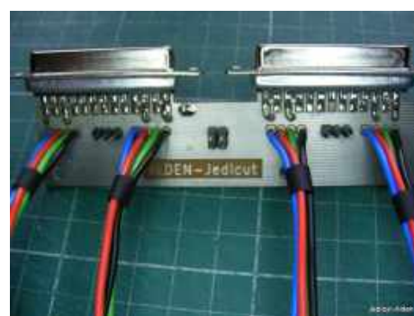
Gniazda DB25 i kable są lutowane
