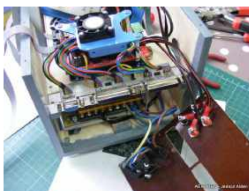
Widok złącza sieciowego wyposażonego w bezpiecznik 5 × 28 A; Idealnym byłby bezpiecznik opóźniony o wartości 5 A wytrzymujący pobór prądu rozruchowego z 2 zasilaczy impulsowych.
