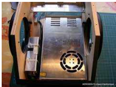
Zasilanie gorącego drutu po prawej stronie 36V 10A i zasilacz 12V 10A po lewej stronie bez skrzynki w celu lepszego chłodzenia.
