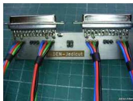
Do DB25 przewody są przylutowane
