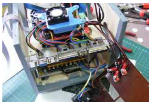
Widok złącza sieciowego wyposażonego w bezpiecznik 5 \times 2 \text{ 8 A} ; Idealem byłby bezpiecznik opóźniony o wartości 5 A wytrzymujący pobór prądu rozruchowego z 2 zasilaczy impulsowych.
