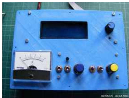
Płyta czołowa, amperomierz wskazuje natężenie prądu przepływającego przez gorący drut.
