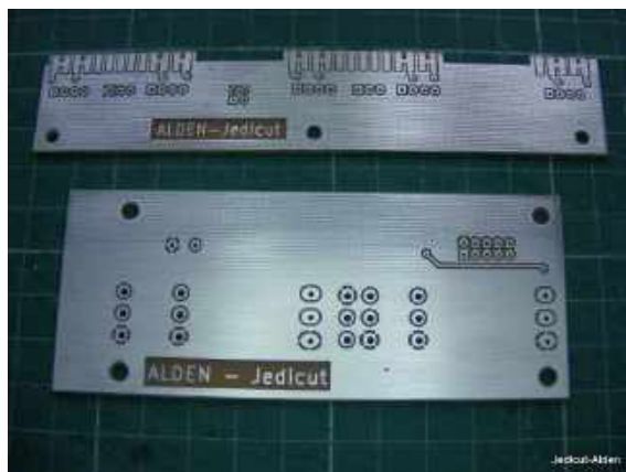
Płytki są odtłuszczone acetonem i cynowane na zimno.
