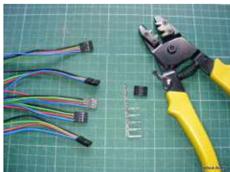
Przygotowanie taśm kabli i gniazd do połączenia z Ramps 1.4
