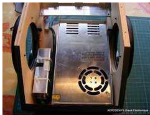
Zasilacz gorącego drutu po prawej stronie 36V 10A i zasilacz elektroniki 12V 10A po lewej stronie, bez obudowy w celu lepszego chłodzenia.
