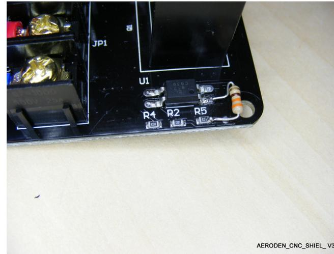
Le module de puissance MosFet a son entrée PWM prévue pour un signal de 12V. Notre signal sortant de L'Arduino UNO est de 5V. Il est donc nécessaire de modifier la résistance qui est en série avec la diode led de l'opto-coupleur. J'ai soudé une résistance de 330 ohms en parallèle sur la résistance R5 de 10K.
